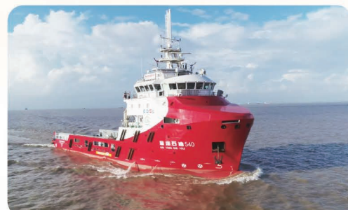
4000马力LNG 动力守护供应船
